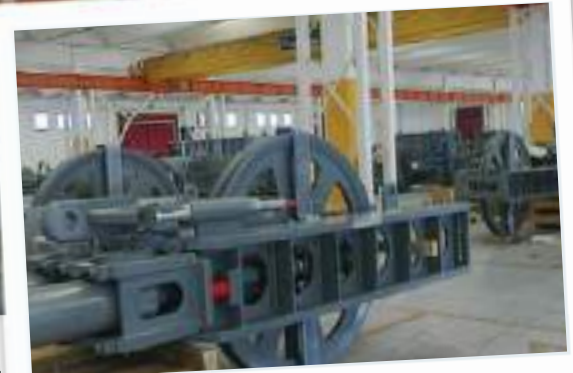
Las poleas forjadas a rodillo producen desempeños notables
